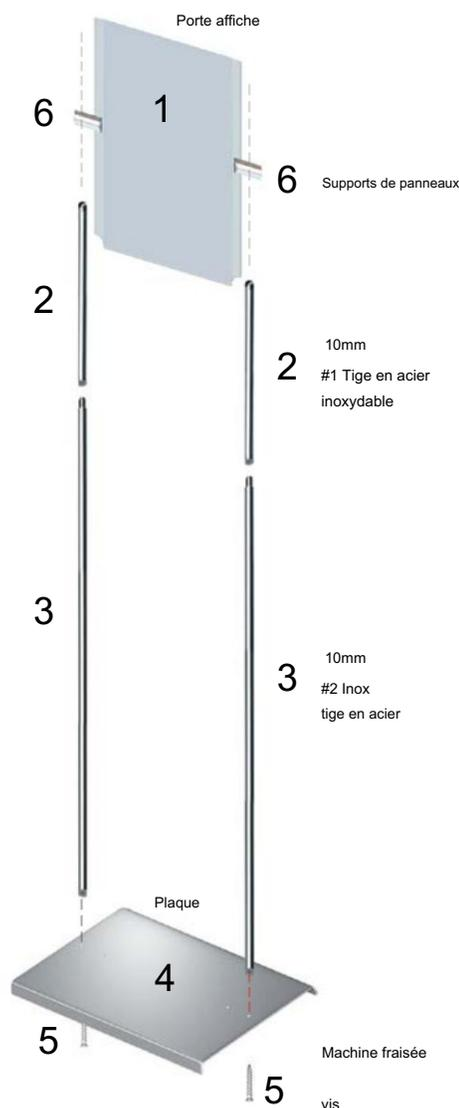
1. Au moyen de la vis à métaux fraisée 5 fixez les tiges n°2 3 à la plaque 4 et fixez-les fermement.
